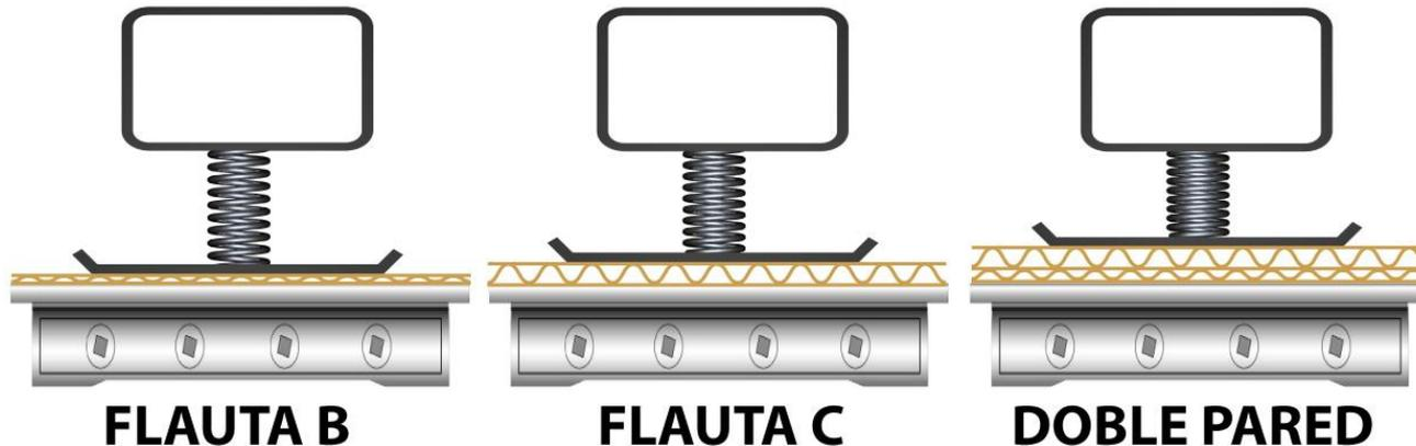
Aún cuando los sistemas de resorte son ajustados para ejercer presión a través de la plancha caliente, estos no se pueden ajustar fácilmente para compensar la diferencia de espesor de láminas. Si los resortes son calibrados para una presión ideal en flauta B se creará una presión y arrastre excesivo cuando se corra flauta C y pared doble.
