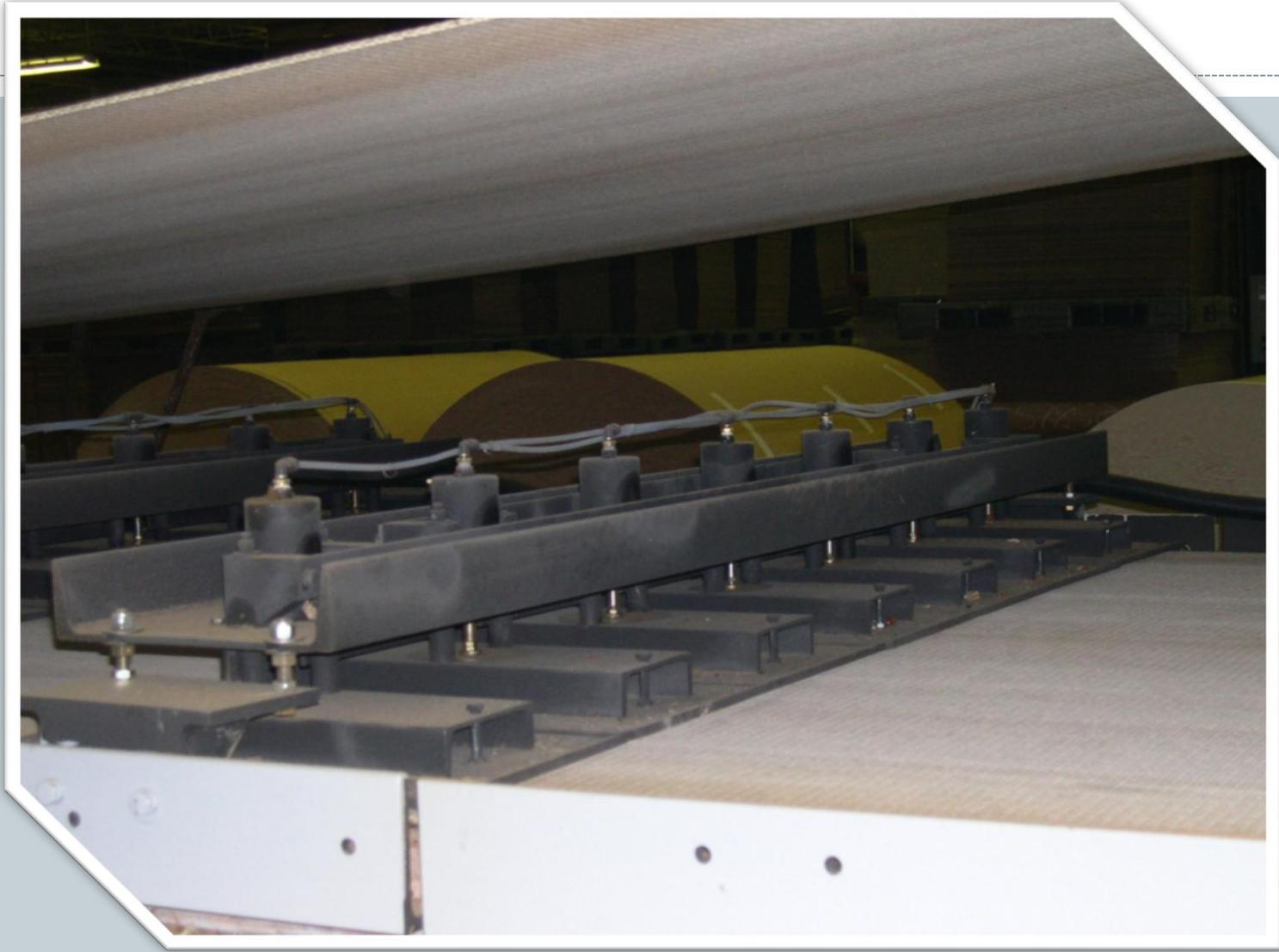
Los cilindros de doble acción mantienen una presión constante independientemente del grosor de la lámina.
